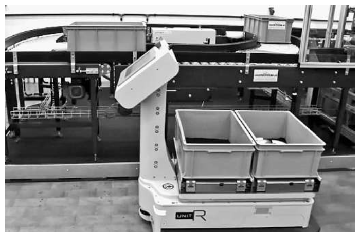
Stationäre Fördertechnik und fahrerloses Transportsystem arbeiten zusammen.
