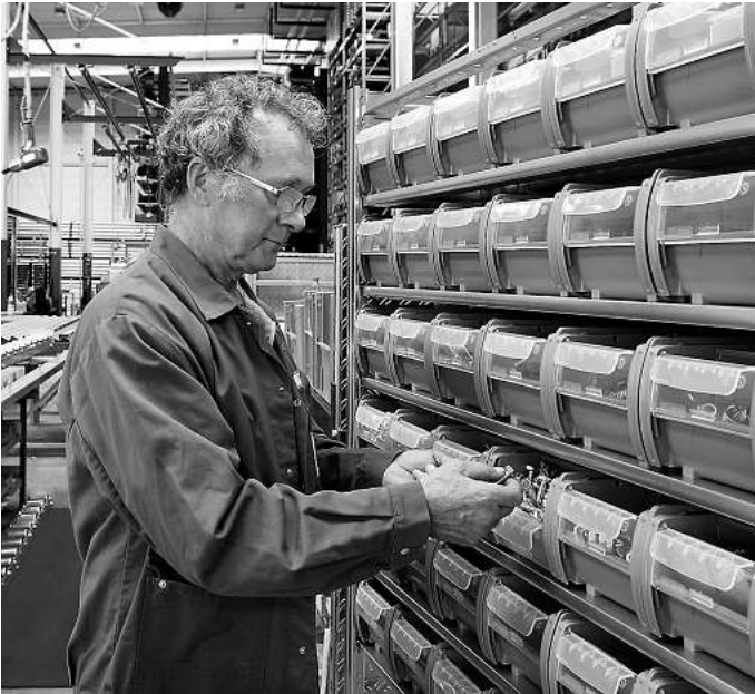
Der neue Kanban-Behälter von BITO. Die ergonomische Entnahmeöffnung ist mit einer transparenten Schiebescheibe verschlossen. Der Werker erkennt auf einen Blick, ob er gefüllt ist. Ware kann er einfach entnehmen.
