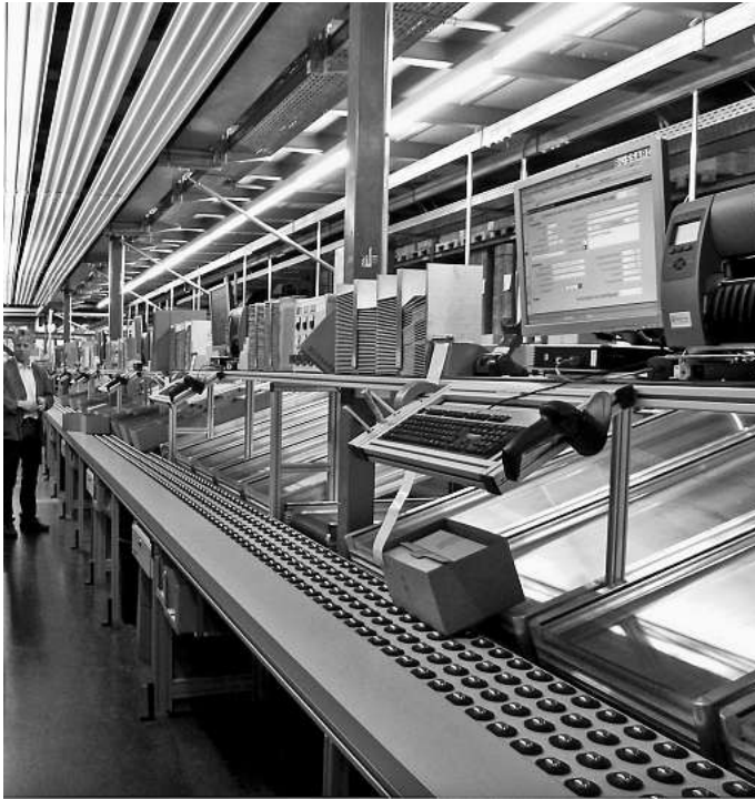
Am neuen Sorter für die Logistiksystem-Aufträge werden die Transport-Units positionsrein und in der richtigen Reihenfolge, analog der Auftragspositionen, automatisch bereitgestellt.
