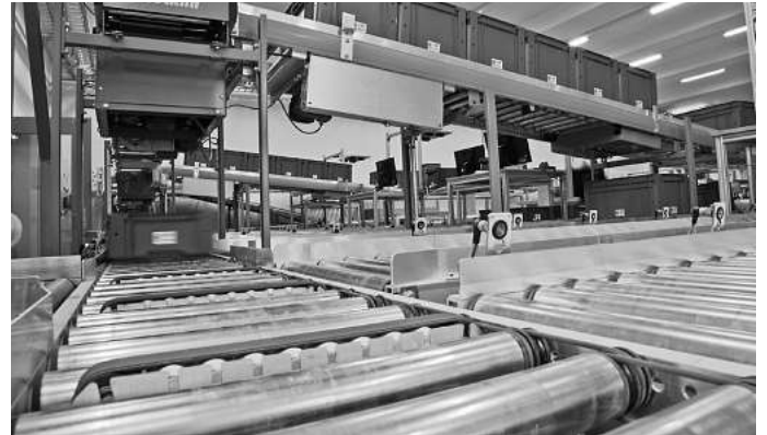
Behälteranlage in der Kommissionierhalle.
