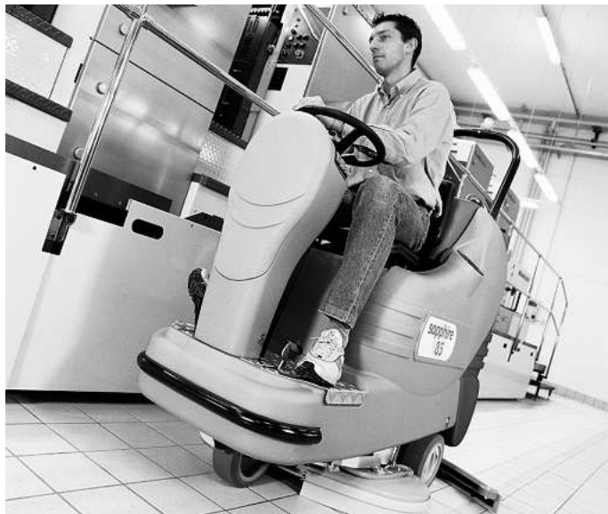
Adiatek-Sapphire 120 Liter Wasser und 88 cm Arbeitsbreite sorgen mitunter für eine grosse Flächenleistung.
