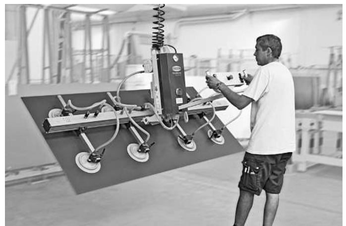
Das Vakuum-Hebegerät VacuMaster eignet sich für die sichere und gesundheitsschonende Handhabung von schweren Lasten wie beispielsweise Metallplatten bis 2000 Kilogramm.
