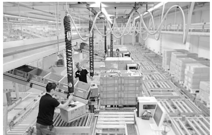
Mit dem Vakuum-Schlauchheber JumboFlex werden Lasten bis 35 kg mit einer Hand schnell und ergonomisch bewegt.
