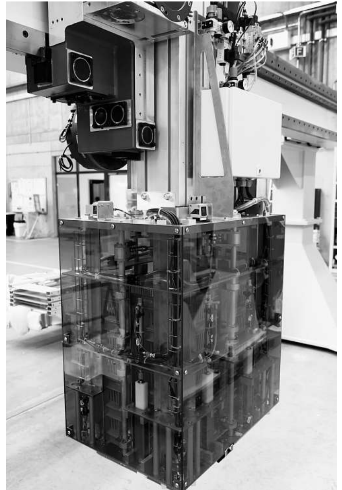
Der massgeschneiderte Greifer setzt die Stapel sicher auf dem Förderband ab.
