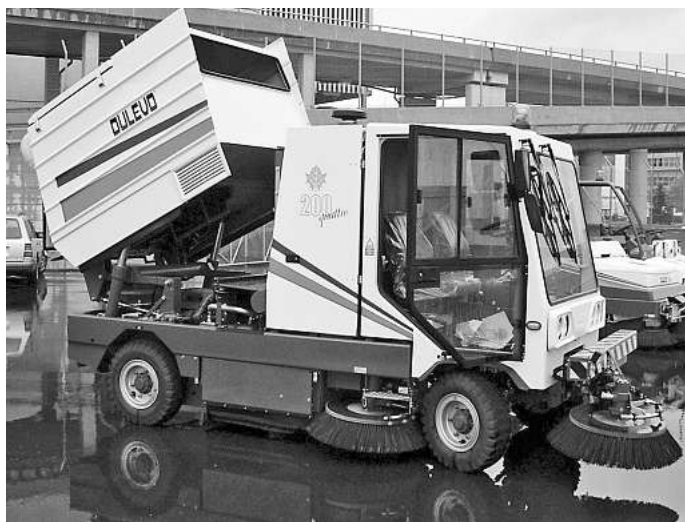
Schmutzbehälter wird zur Entleerung hochgefahren.
