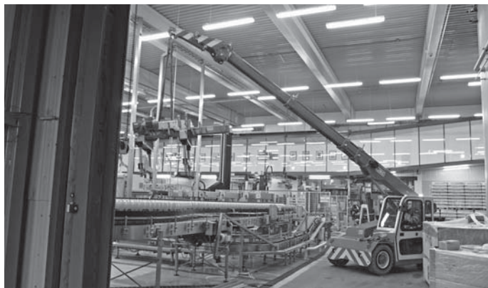
MC60: Mit dem Pick & Carry Mobilkran MC60 6 t können schwere Elemente in Werkhallen positionsgenau platziert werden.
