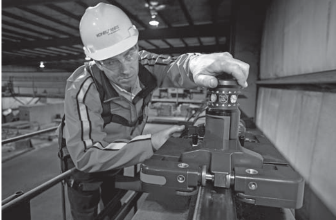
RailQ vermisst die Ausrichtung der Kranbahn und identifiziert Unebenheiten haarklein.
