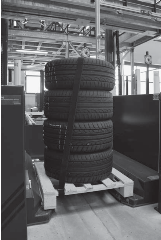
Die speziellen Holzpaletten können bis zu vier Autoreifen aufnehmen und sind für ein Gewicht von 140 kg konzipiert.
