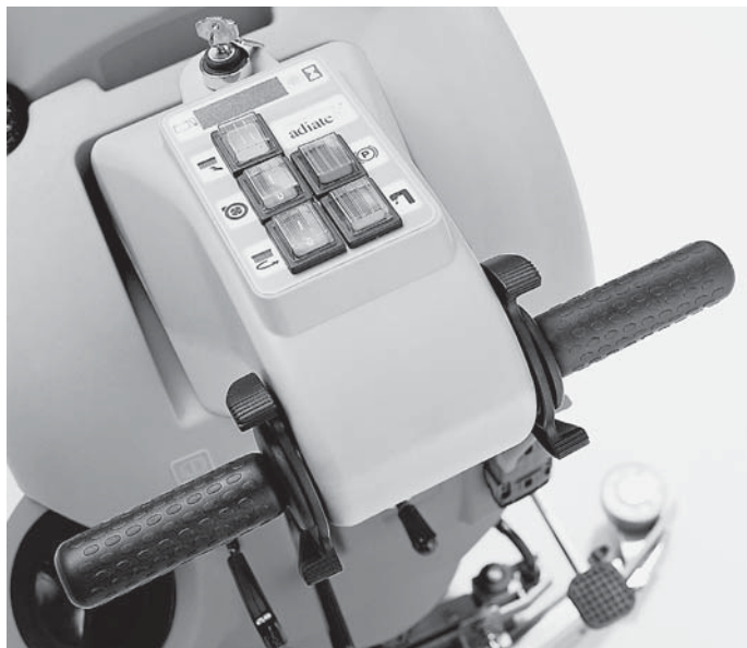
Übersichtlich angebracht – leicht zu verstehen. Instrumentenboard bei Adiatek-Maschinen.
