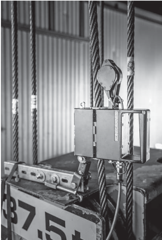
RopeQ, das Tool zur magnetischen Seilinspektion.
