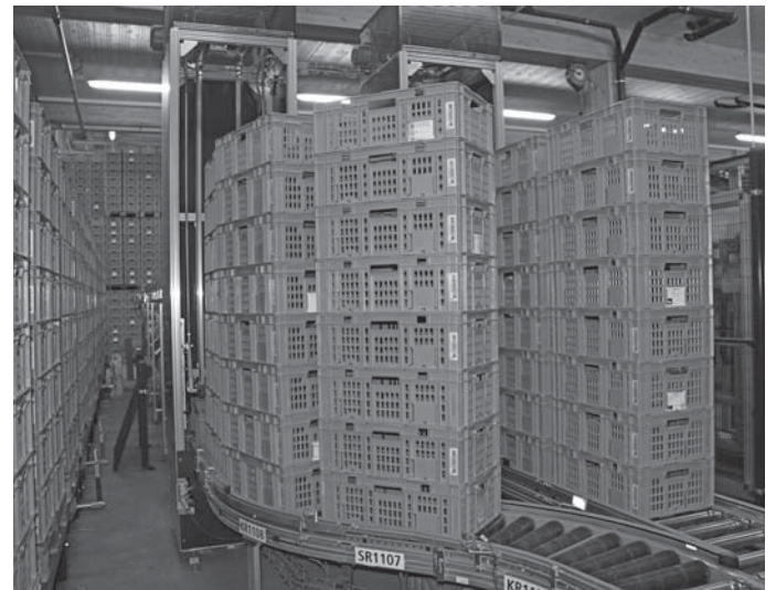
Das Abschieben der Gebindetürme, die Gebindevereinzelung, die Abstapelung und das Aufrichten der zusammengeklappten Gebinde erfolgen vollautomatisch.
