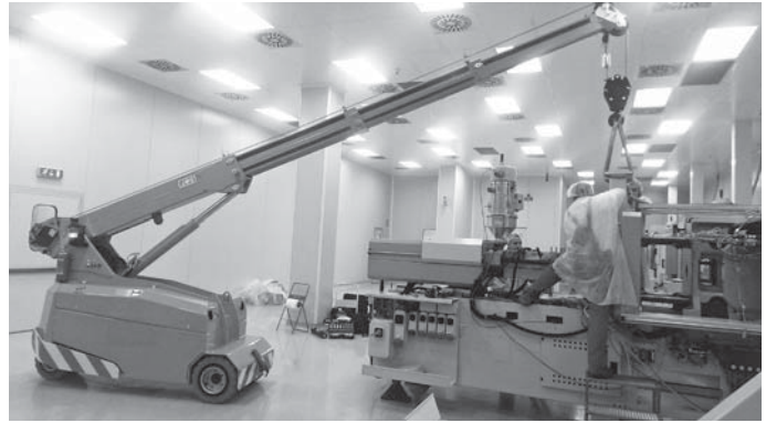
MC32: In beengten Räumen leistet der MC32 seine Dienste und wird problemlos über den Joystick an den Funkfernsteuerung bedient.
