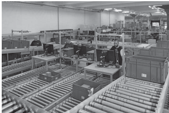
Abb. 3: Kommissioniervorzone eines aut. Kleinteilelagers bei Hans Kohler AG. Quelle: HZDS
