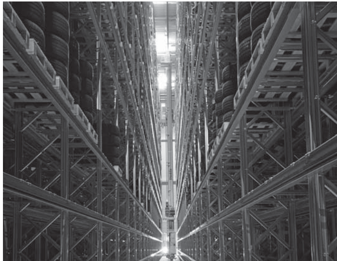
Das automatische Pneulager bietet in den drei Gassen Platz für die einfachtiefe Querlagerung von rund 10000 Europaletten.
