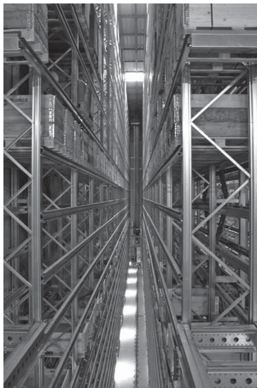
Abb. 4: Ein Blick in ein Hochregallager mit einem Paletten-RBG bei Hans Kohler AG. Quelle: agiplan/Stöcklin
