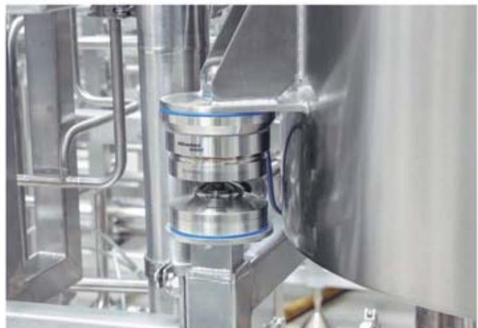
Materialverluste minimieren: Mit dem Wägemodul Novego® im Hygienic Design können aus Tanks mit einem Fassungsvermögen von mehreren Tonnen Kleinstmengen grammgenau dosiert werden.
