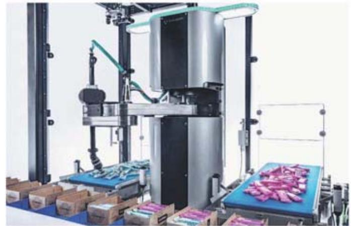
Als Grundlage für die Steuerung des Cobots tog.519 nutzt Schubert eine selbst entwickelte, KI-gestützte Bildverarbeitung.
