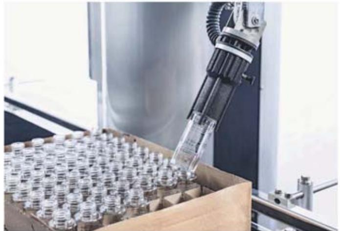
*Die KI-gestützte Bildverarbeitung des Cobot gewährleistet, dass andere Produkte, unterschiedliche Formate oder neue Verpackungsaufgaben ohne zusätzlichen Programmieraufwand sofort verarbeitet werden.*
