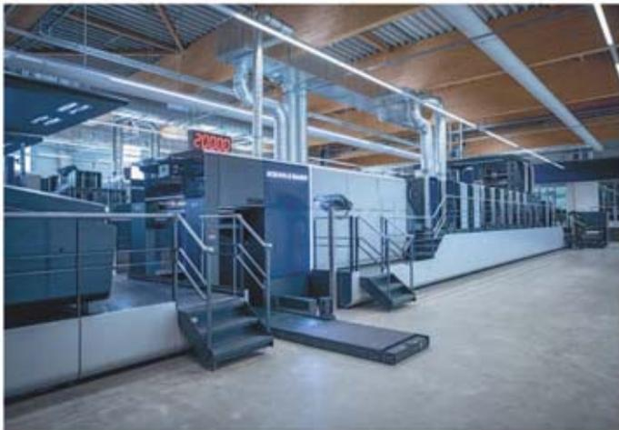
*Für die Verpackungsproduktion höher gesetzte Rapida 106 X mit sieben Druckwerken, Doppellack-Ausstattung sowie einem weiteren Druckwerk nach dem ersten Lackturm.*
