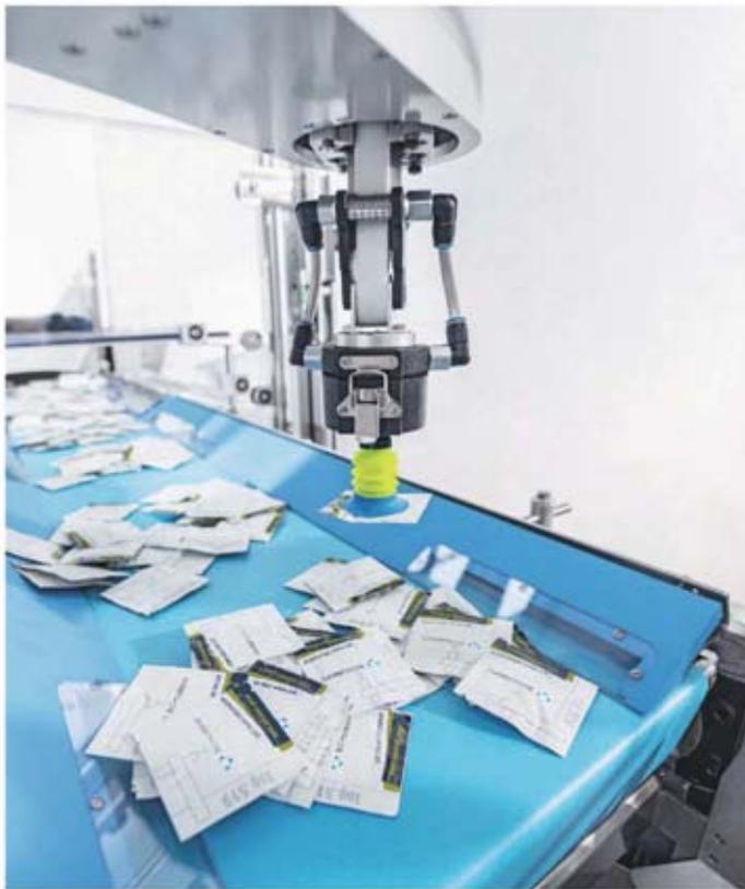
*Durch die selbst entwickelte, KI-gestützte Bildverarbeitung ist der Cobot auch in der Lage, Produkte aus der Unordnung aufzunehmen und woanders zu platzieren.*
